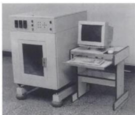
1-сурет - MEM Yinhua жылдам прототиптеу машинасы (лазерлік жылдам қалыптау орталығы ұсынған, Пекин Цинхуа университеті)
